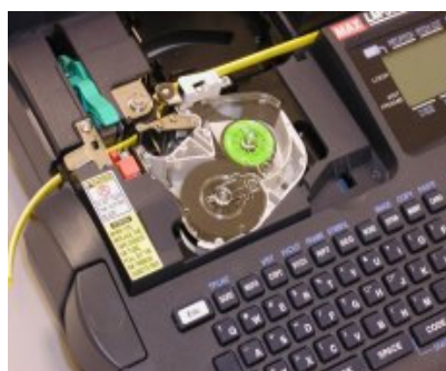
Pilt näitab ProMark trükilinti ja profiili läbisöötü masinast
